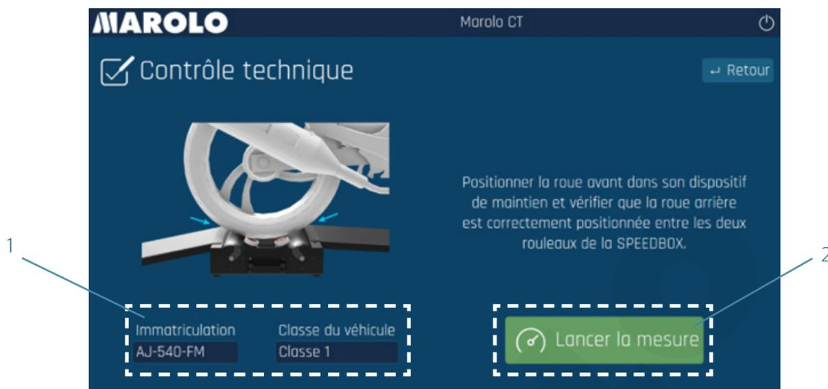
4) Suivre les indications « Accélérer modérément, jusqu'à 5 km/h pour centrage du véhicule », « Accélérer à fond » et « relâcher l'accélérateur » en agissant sur la poignée d'accélération du véhicule contrôlé.
