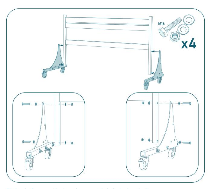
FR: Fixer les flasques sur l'extérieur du support à l'aide des boulons M16 fournis.
