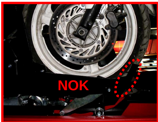
Mauvaise fixation de la roue avant Vé Arrière trop bas
