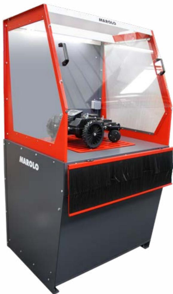
Estación de limpieza en seco para robots cortacésped
