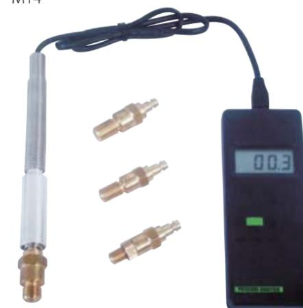
COMPRESIÓMETRO DE GASOLINA MOTOMETER®
