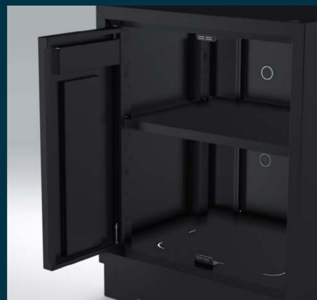
Des omégas renforcent et rigidifient les caissons et les portes du mobilier. Des aimants de maintien protègent les portes et permettent de réduire le bruit lors de l'utilisation. Un système de gonds sur ressort permet d'enlever rapidement la porte si besoin, et un insert plastique limite l'apparition de bruit et de jeu dans le temps.
