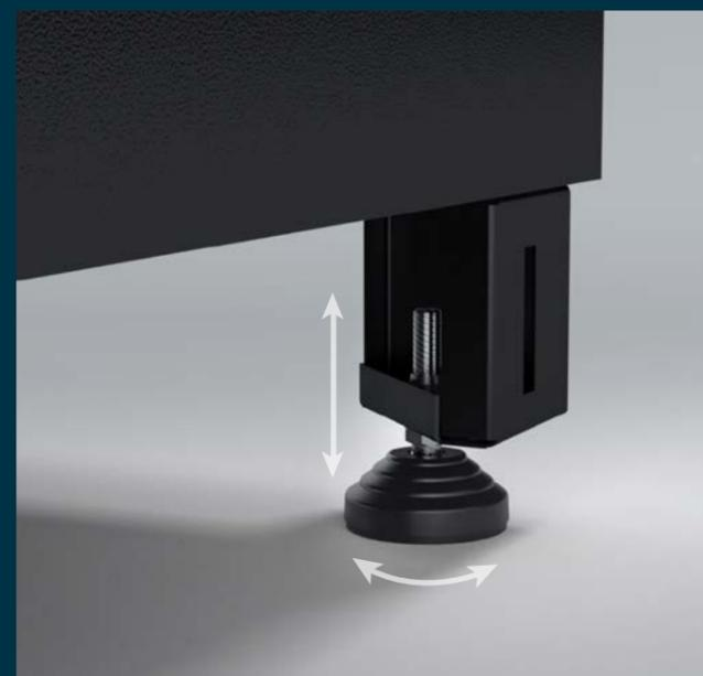
Les meubles sont soutenus par des pieds en tôle 15/10, soudés pour garantir une bonne stabilité de l'ensemble. Le pied est monté sur rotule et facilement ajustable en hauteur depuis l'extérieur, avec une amplitude de réglage de 2,5 cm.
