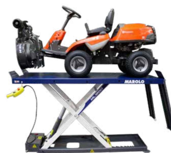
Capacité maximale : 600 kg <
